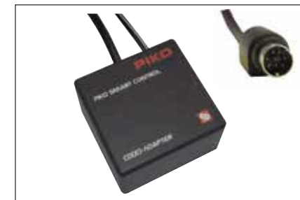
55043 19,99 €* CD(E)-Adapter für SmartBox - für DCC Boostersysteme Eingang: Anschluss an "ECoSlink" / Ausgang: CD(E)-Anschlüsse (2-poliges Schraubterminal) Aus technischen Gründen ist es leider nicht möglich, die "E"-Leitung an diesem Adapter zu realisieren, d.h. eine Kurzschlussrückmeldung an die Zentrale ist nicht realisierbar
