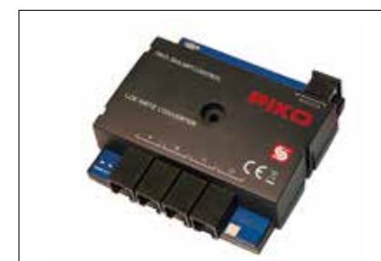
55044 49,99 €* PIKO Lok-Netz Converter Mit Hilfe des PIKO Lok-Netz Converters kann die PIKO SmartBox in ein LocoNet® Netzwerk eingebunden werden. Der Adapter bietet vier Anschlussbuchsen und wird direkt über die PIKO SmartBox mit bis zu 500mA Strom versorgt.
